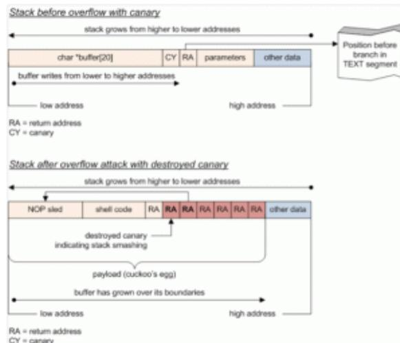
Il compilatore GCC inserisce nello Stack, prima dell'indirizzo di ritorno, un byte "canary" (canarino). Se l'indirizzo di ritorno viene sovrascritto, anche il canary è sovrascritto. Appena il programma si accorge che il canary non ha più il valore originale, si interrompe impedendo l'esecuzione dello shellcode.
