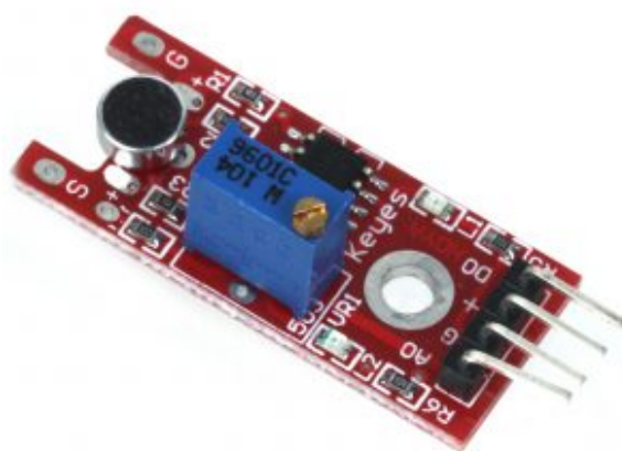
Il microfono KY-038 per Arduino
