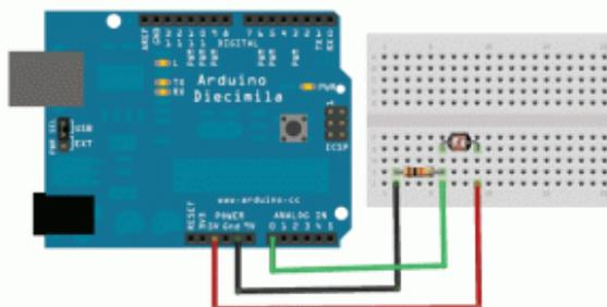
Il potenziometro può essere facilmente sostituito con una fotoresistenza
