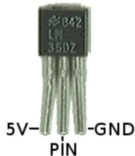
I pin del sensore LM35 sono facili da riconoscere: guardando il lato piatto, da sinistra abbiamo il pin 5V (positivo), quello analogico, e il pin GND (negativo)
