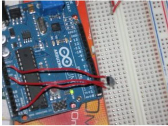
Per collegare un sensore di temperatura a Arduino bastano tre cavi e una breadboard
